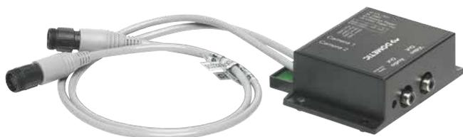
Mit der Schaltbox PerfectView SWITCH 200VTO und dem passenden fahrzeugspezifischen Adapter können Sie zwei Kameras an ein werkseitig eingebautes Multimediasdisplay anschließen. Die Kameras werden manuell oder automatisch aktiviert. Über den externen Schalter können Sie manuell zwischen den beiden Ansichten hin- und herwechseln.
